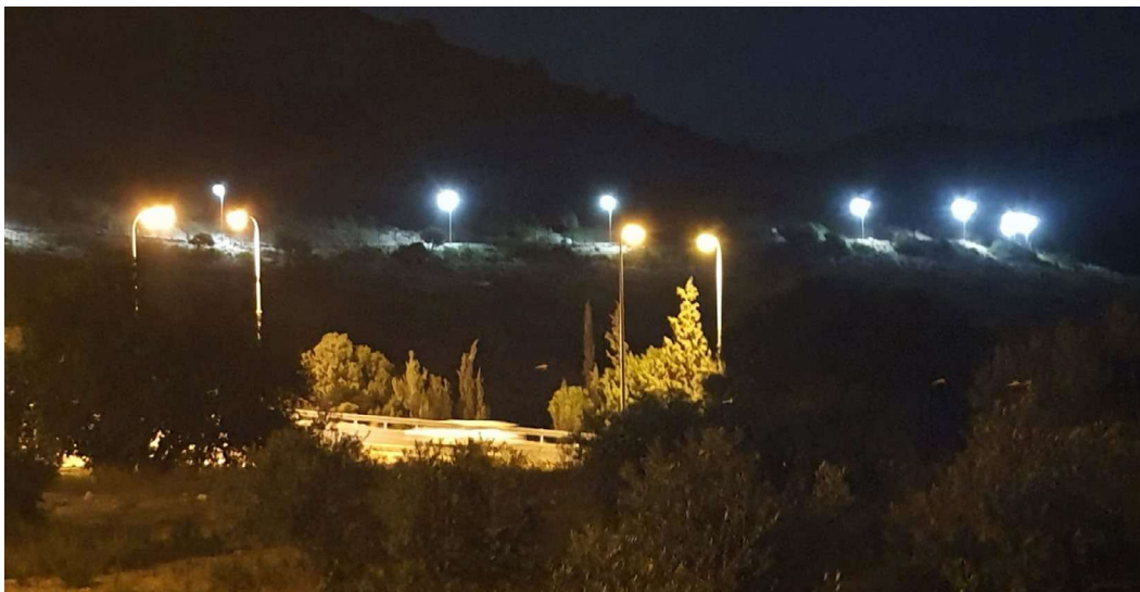
תמונה מס' 1: מאחור - גוון נורת לד באור "קר" לעומת תאורה קדמית שהיא בגוון אור "חם" בנורות פריקה קלאסיות של נתרן בלחץ גבוה (נל"ג) (10) | צילום: דניאלה וטין
