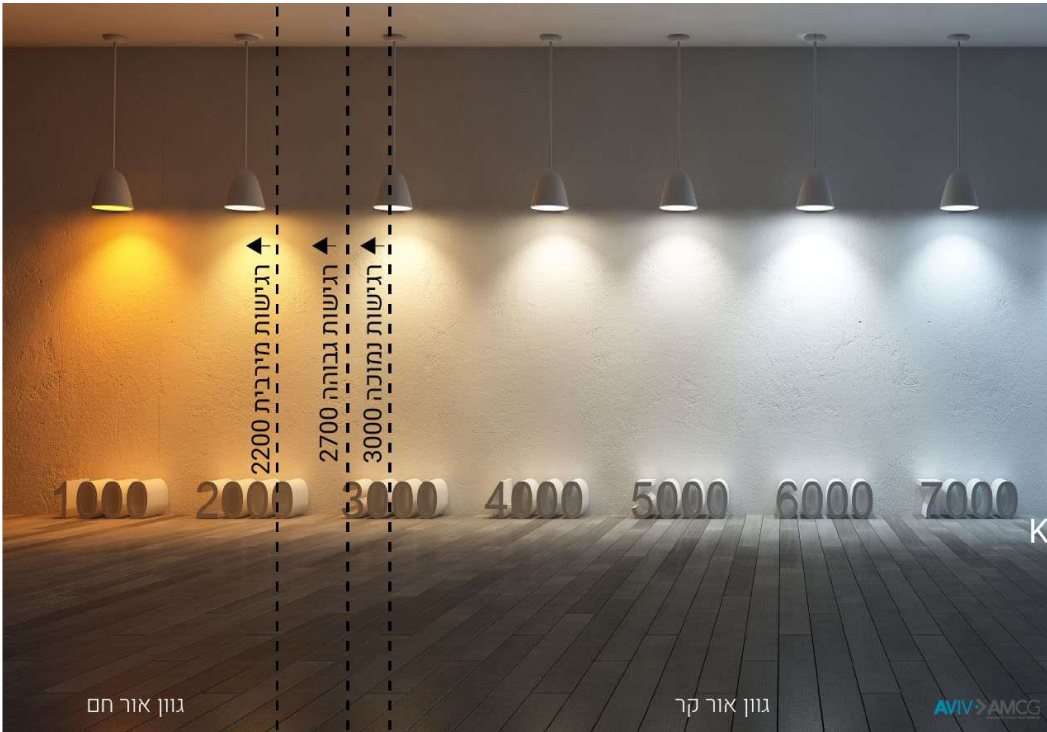
איור 12: סקלת גווני אור בקלווין - גוון אור קר (מימין) הוא בעל השפעה אקולוגית שלילית בשעות הלילה. יש להשתמש בגוון אור מ-3000 K ומטה בהתאם לרמת הרגישות במרחב.
